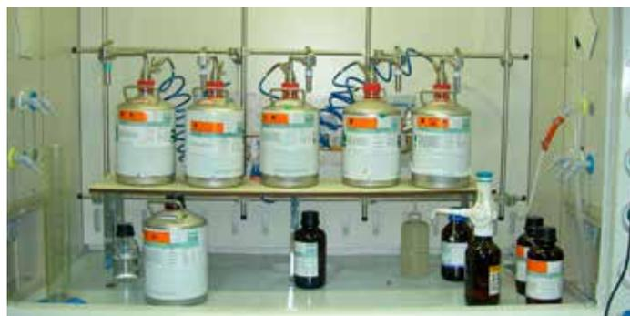
Ejemplo: para la distribución de varios disolventes a baja presión de nitrógeno - compatible con calidad HPLC
